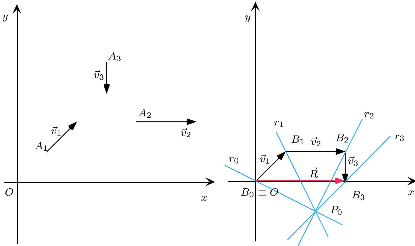
Scelto  $P_0(2, -1, 0) \in$  piano  $Oxy$ , tracciamo le rette  $r_i, i = 0, 1, 2, 3$ , che congiungono  $P_0$  con i rispettivi  $B_i$ . Scelto  $C_0(0, 2, 0) \in$  piano  $Oxy$ , tracciamo le rette  $s_i$  ed individuiamo i punti  $C_i$ . La retta passante per  $O' = s_0 \cap s_3$  e parallela ad  $\vec{R}$  è l'asse centrale del sistema  $\Sigma_\pi$ . Inoltre  $\Sigma_\pi \approx (O', \vec{R})$ .
